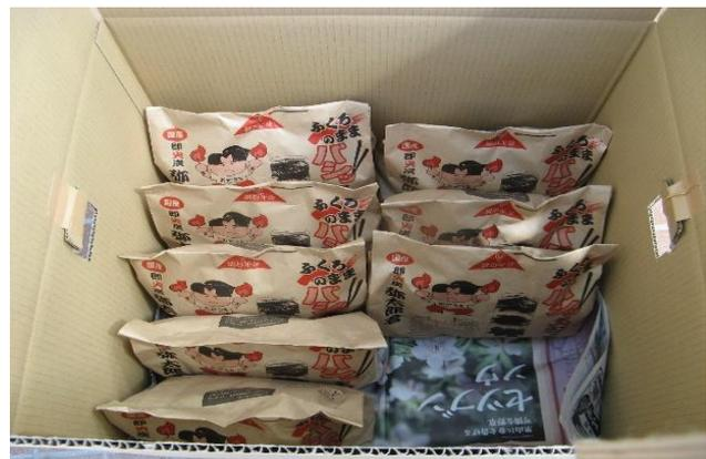
最初に木炭を6～7cmに切断、その後、杉枯れ葉、割り箸炭、木炭をそれぞれ一定重量を計量、1袋に詰める。総重量、外観等最終チェックし、15袋入りの段ボールに入れる（写真右）。これを8人程度が流れ作業で行う。（写真左）
